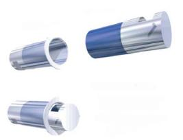
Die sichtbaren Teile des Ventils können sowohl in eloxiertem Aluminium als auch in Kupfer geliefert werden. Die Ventilröhren sind aus Kunststoff in Standardlänge von 400 mm gefertigt und werden in Situ angepasst. Das Ventil wird standardgemäss mit Wärmeund Lärmisolierung geliefert. Insekten-, Sturm,- oder Pollenfilter können gegen Mehrpreis gemäß unserer Preisliste geliefert werden.
